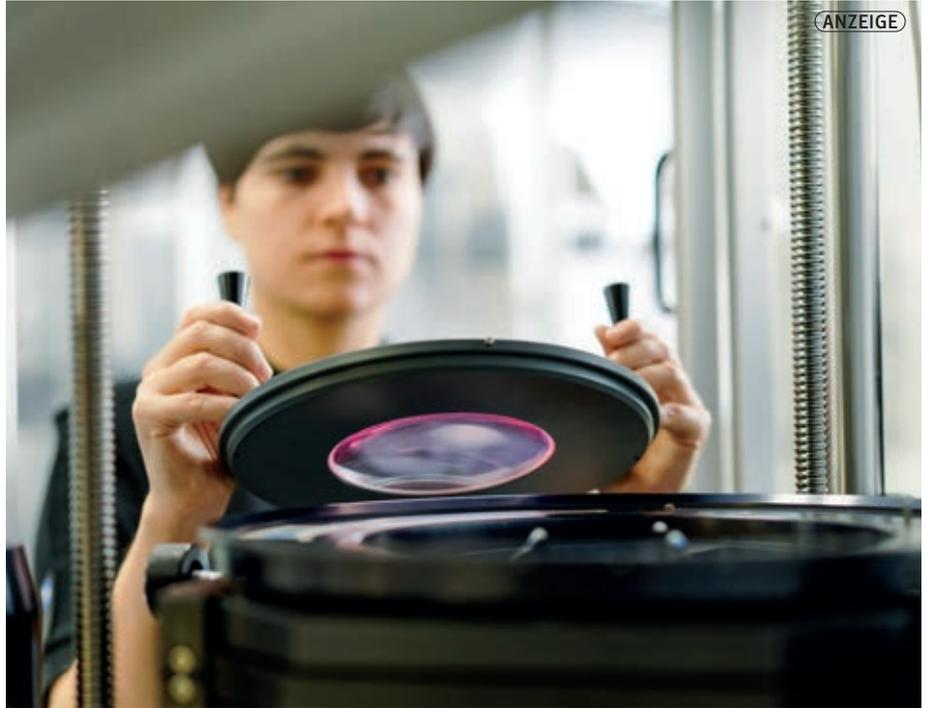
**UM UNEBENHEITEN DER LINSENFLÄCHE ABZUTRAGEN,** stellt Sandra an der Maschine unterschiedliche Bewegungen und Geschwindigkeiten ein. Manchmal poliert sie die Linsen auch mit der Hand.
